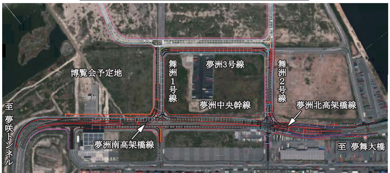
夢洲南高架橋下部工を避けた夢洲中央幹線迂回路施工状況
