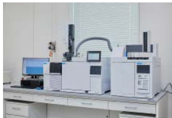
多様な設備機器を配置（左：LC/IC 右HSGC/MS）
