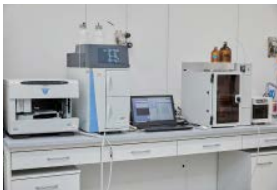
多様な設備機器を配置（左：LC/IC 右HSGC/MS）
