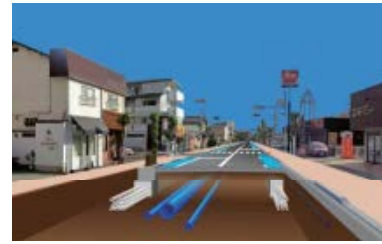
電線共同溝整備イメージ図
